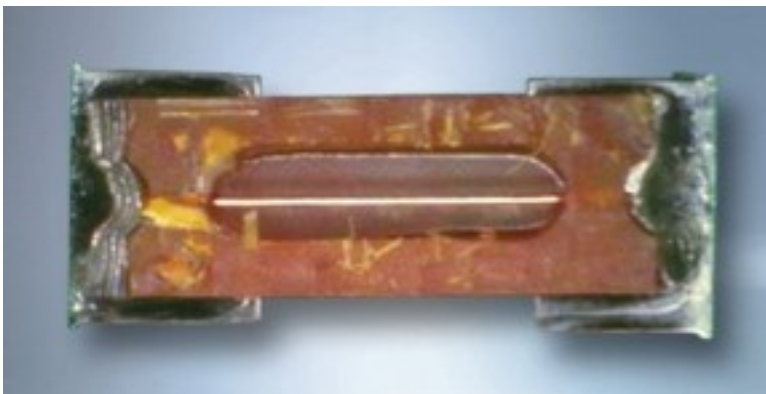
Abb. 4: Querschnittansicht der internen Struktur einer AirMatrix-Sicherung. Das direkt verbindende Design sorgt für Zuverlässigkeit.
