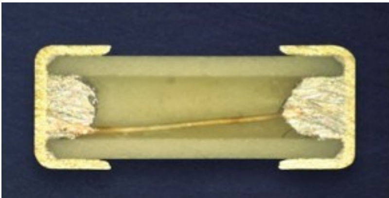
Abb. 1: Querschnittsansicht einer herkömmlichen Draht-in-Luft-Keramik-Röhrensicherung. Insbesondere die Lötverbindungen sind eine Sicherheitschwachstelle.
